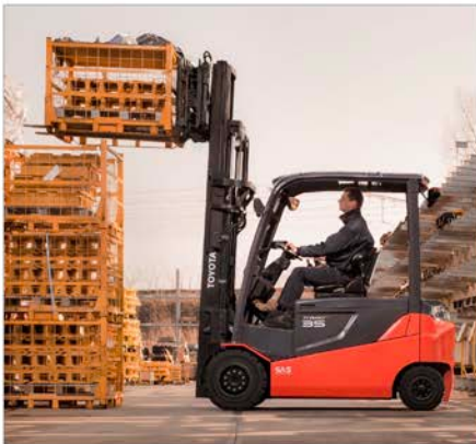
Beim klassischen Frontstapler befindet sich der Hubmast fest vor der Vorderachse.
