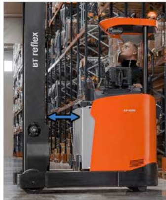
Beim Schubmaststapler kann der Hubmast entlang der Radarme verschoben werden.
