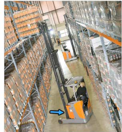
In jedem Fall Schubmast einfahren beim Kurvenfahren.
