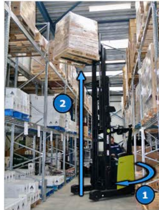
Beim Einlagern: Erst Kurve fahren, dann Last anheben.
